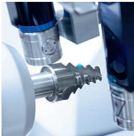
*Der Laser vermisst einen Fräser mit Tannenbaumprofil für die Turbinenindustrie*
