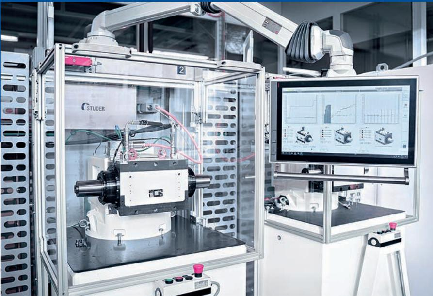
Die modernisierten Spindelprüfstände sind schwingungsentkoppelt, individuell ansteuerbar und verfügen über präzise Sensorik
