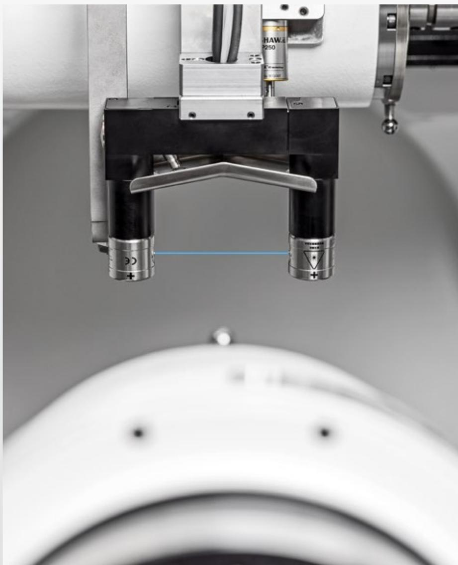
WALTERは、オプションとして画期的な新型LASER Contour Checkを開発しました。円筒工具の工具パラメーターを高精度かつ非接触で工程内で測定できます。放電加工機、研削盤に搭載できます。ぜひ、活用ください。
